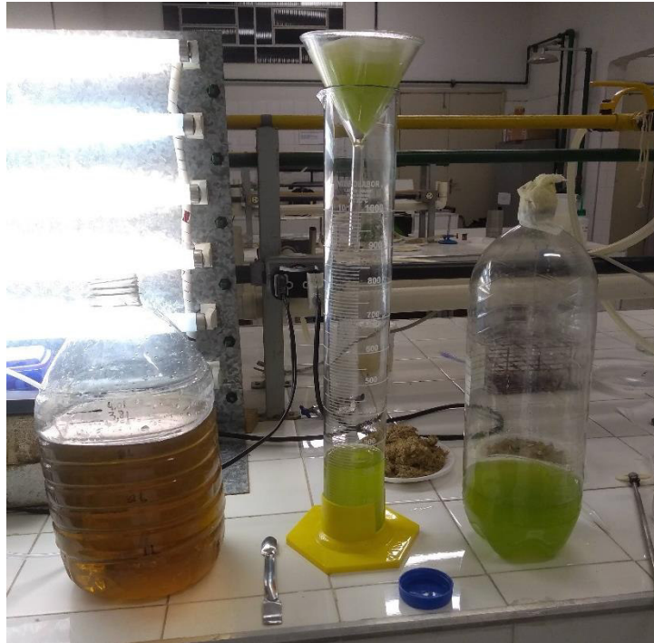
Figura 8 - Aparato experimental do cultivo de Chlorella minutíssima
